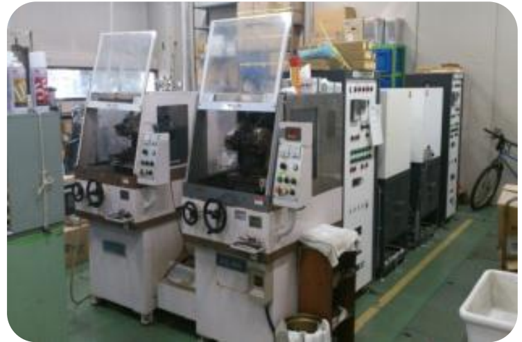
切割機(左方有玻璃蓋)與加溫爐(右後方白色面板儀器)
