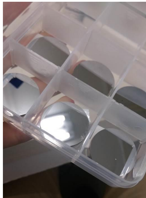
拋光完成的 SUS420 不鏽鋼試片
