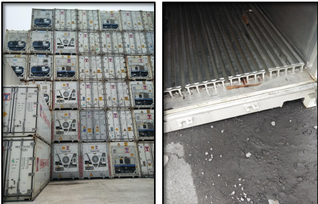
陽明冷凍櫃堆放處，冷櫃貨物多為生鮮食品，可能有水分滲出，因此冷櫃底部會有架高導流的設計，避免水分浸濕貨物底部導致損壞
