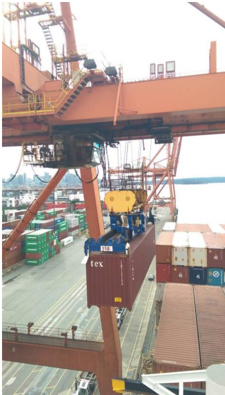
圖八 橋式起重機運作
