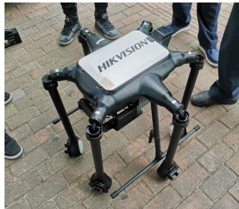
照片 6 「立方衛星酬載 AIS 建構海域監測系統」照片 說明 AIS 立方衛星飛行版與無人機搭載 AIS 設備飛行測試。
