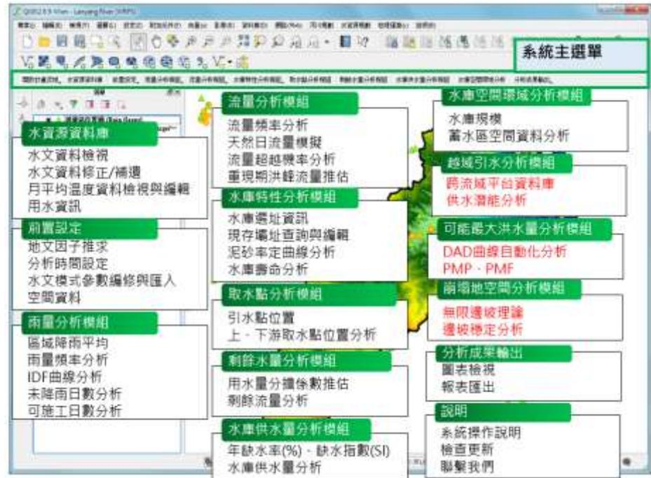
圖 1 集水區水源應用規劃作業平台架構
