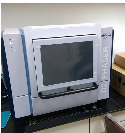
照片 2 X 光粉末繞射儀
